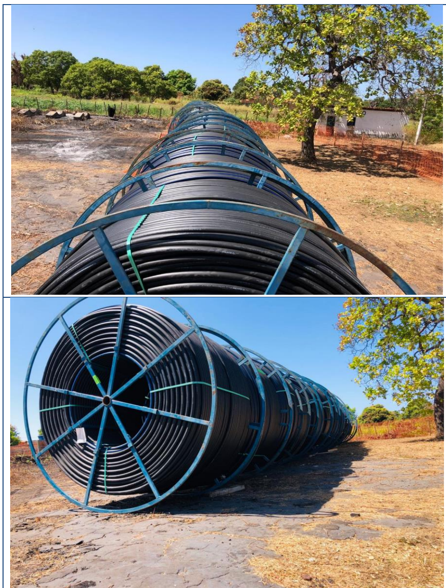
Imagem 88 Duto flexível de telecomunicações em PEAD
