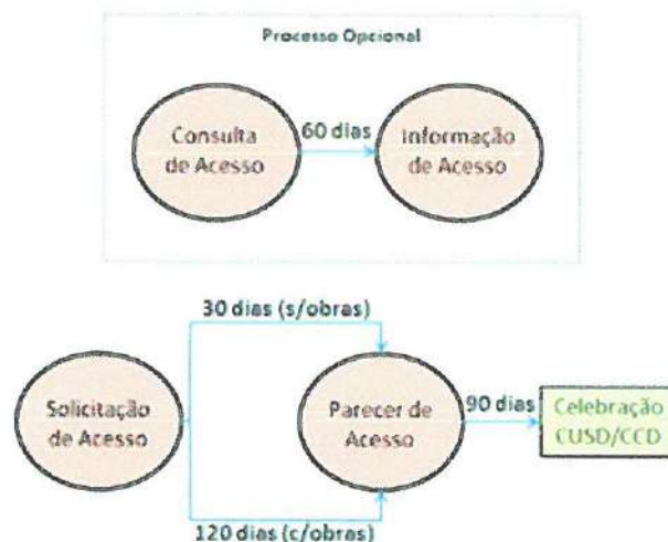
Figura 7: Etapas para viabilização do acesso
