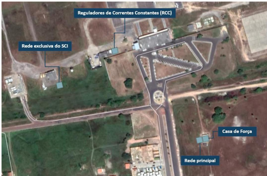
**Figura 44. Localização das entradas de energia, casa de força e RCC do aeroporto**
