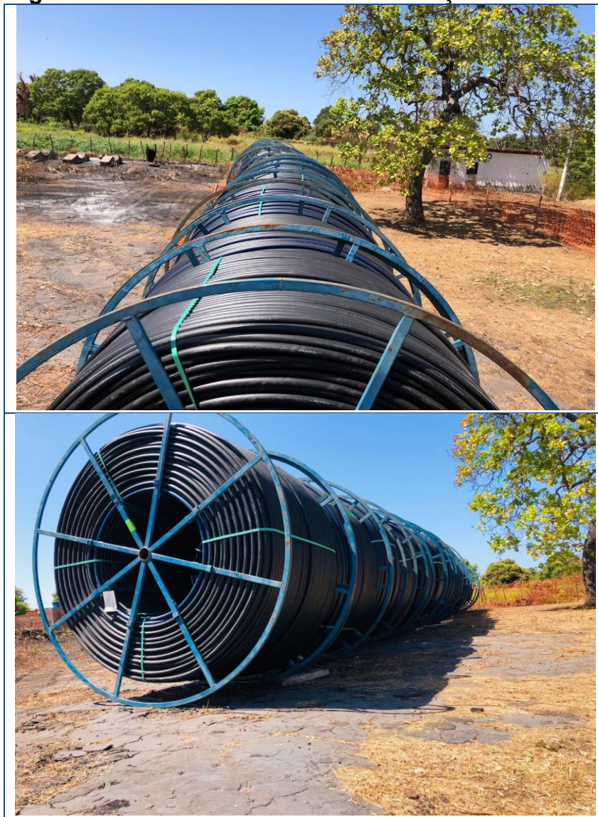
Figura 6 – Duto flexível de telecomunicações em PEAD
