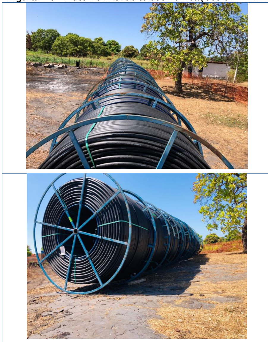
Figura 220 – Duto flexível de telecomunicações em PEAD
