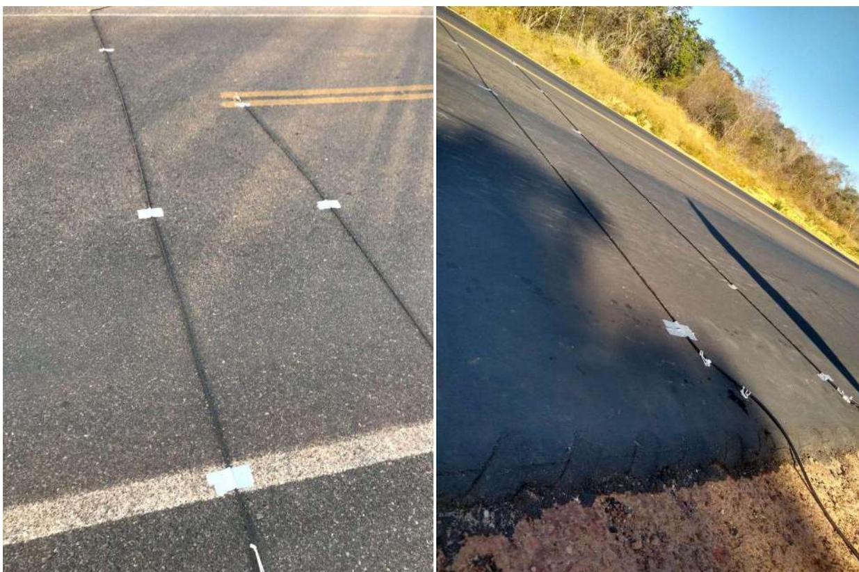
Figura 20: Ilustração dos contadores pneumáticos instalados nas rodovias
