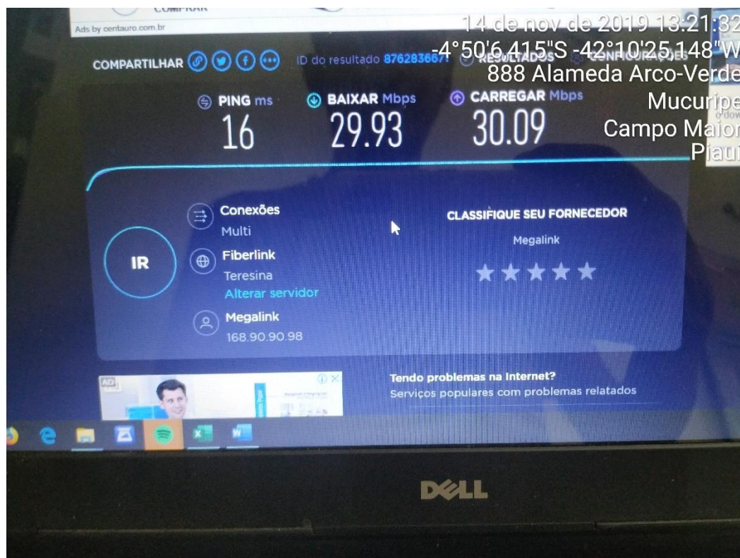
Imagem 63 – Registro do Testador Speedtest comprovando Velocidade Nominal de Internet entregue – PAG – Campo Maior
