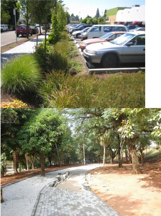
**Figura 27 - Exemplo de biovaleta junto a estacionamento e caminho de pedestres**
